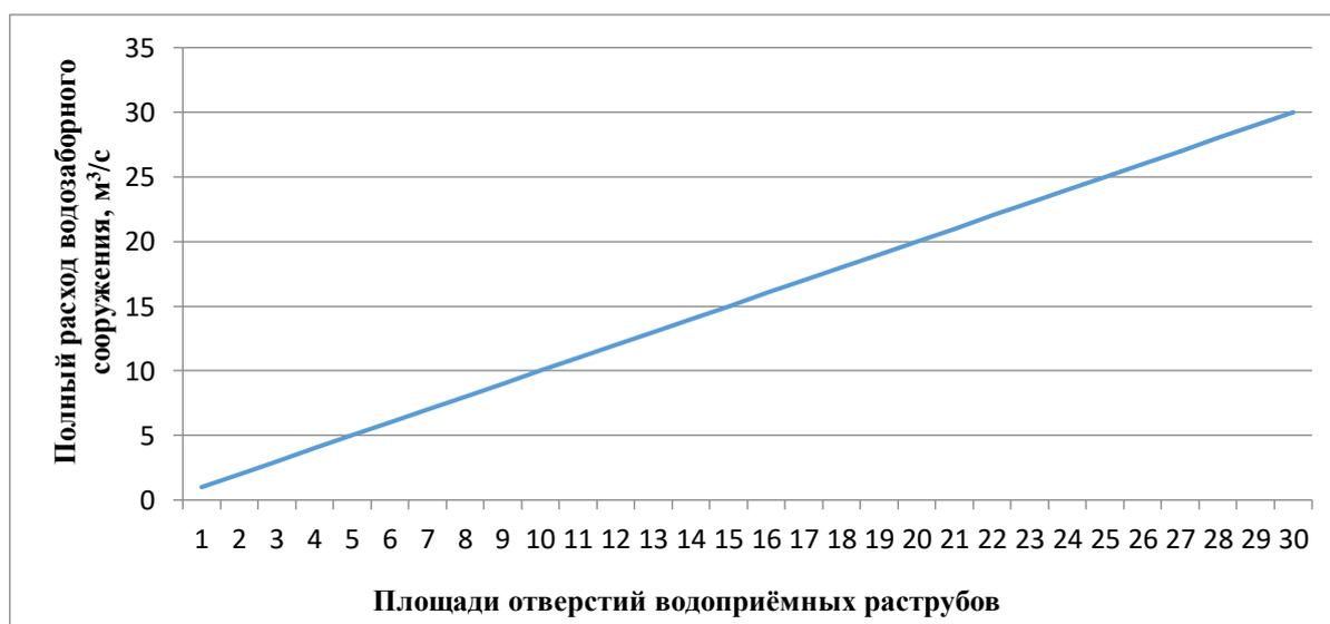
Рисунок 2– Зависимость расхода водозаборного сооружения от площади решеток, установленных на водозаборном раструбе
